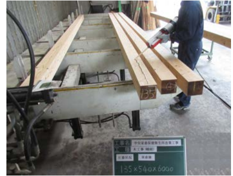
(正角を用いた接着重ね材の制作)
