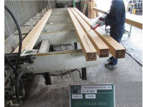
(正角を用いた接着重ね材の制作)
